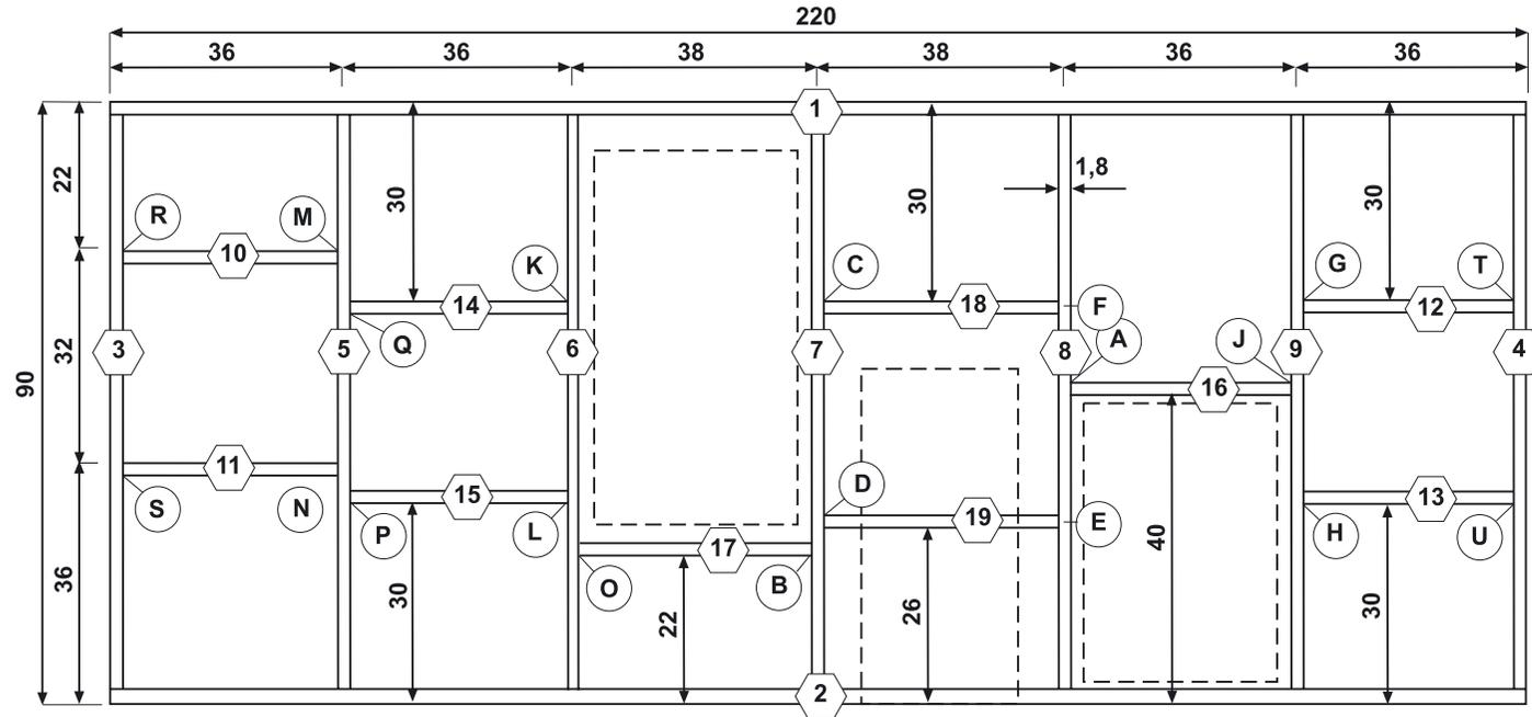
Im Plan für den Grundrahmen bezeichnen die Zahlen 1 bis 19 die einzelnen Streben, die Buchstaben A bis U die Reihenfolge der Verschraubung. Diese Abfolge gewährleistet ausreichend Spielraum zum Eindrehen der Schrauben.
