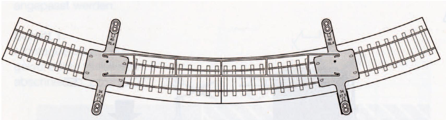
Position des neuen Mastfußes markieren und an dieser Stelle den Mastfuß festschrauben.
