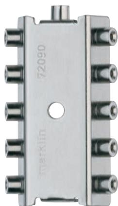
**Nützliches Zubehör: Verteilerplatte (Art. 72090)** Geeignet für elf Stecker nach neuem Standard. Alle Anschlüsse sind elektrisch verbunden. Die Zuleitung ist auch über einen Stecker der früheren Ausführung möglich. Größe: 47 x 26 Millimeter.
