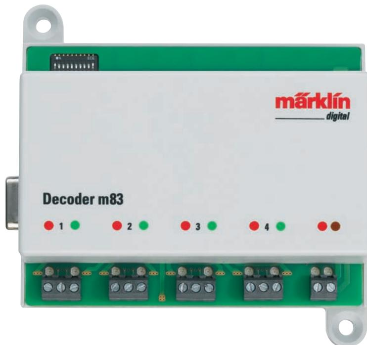
Ebenfalls neu bei dieser Decoder-Generation ist die Unterstützung bei der Fehlersuche. Sind das rote und braune Kabel miteinander vertauscht, wird dies jetzt bei dem Decoder m83 durch zwei blinkende Kontroll-LEDs angezeigt. Dies ist ein fühlbarer Fortschritt gegenüber der Vorgängergeneration, bei der es überhaupt keine Funktionskontrollen gab.
