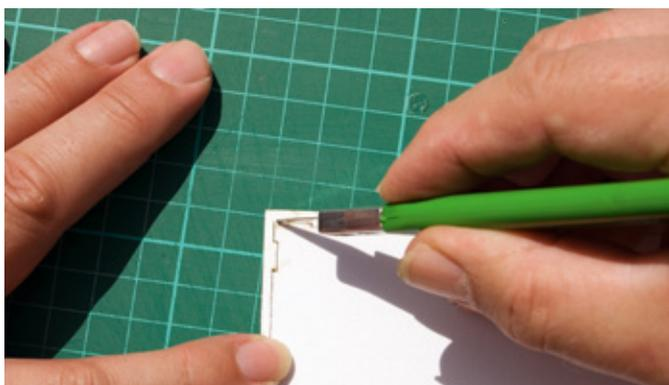
Sauberer Schnitt: Mit einem Bastelmesser lässt sich die Form einfach an den vier Verbindungsstegen vom Rahmen trennen.
