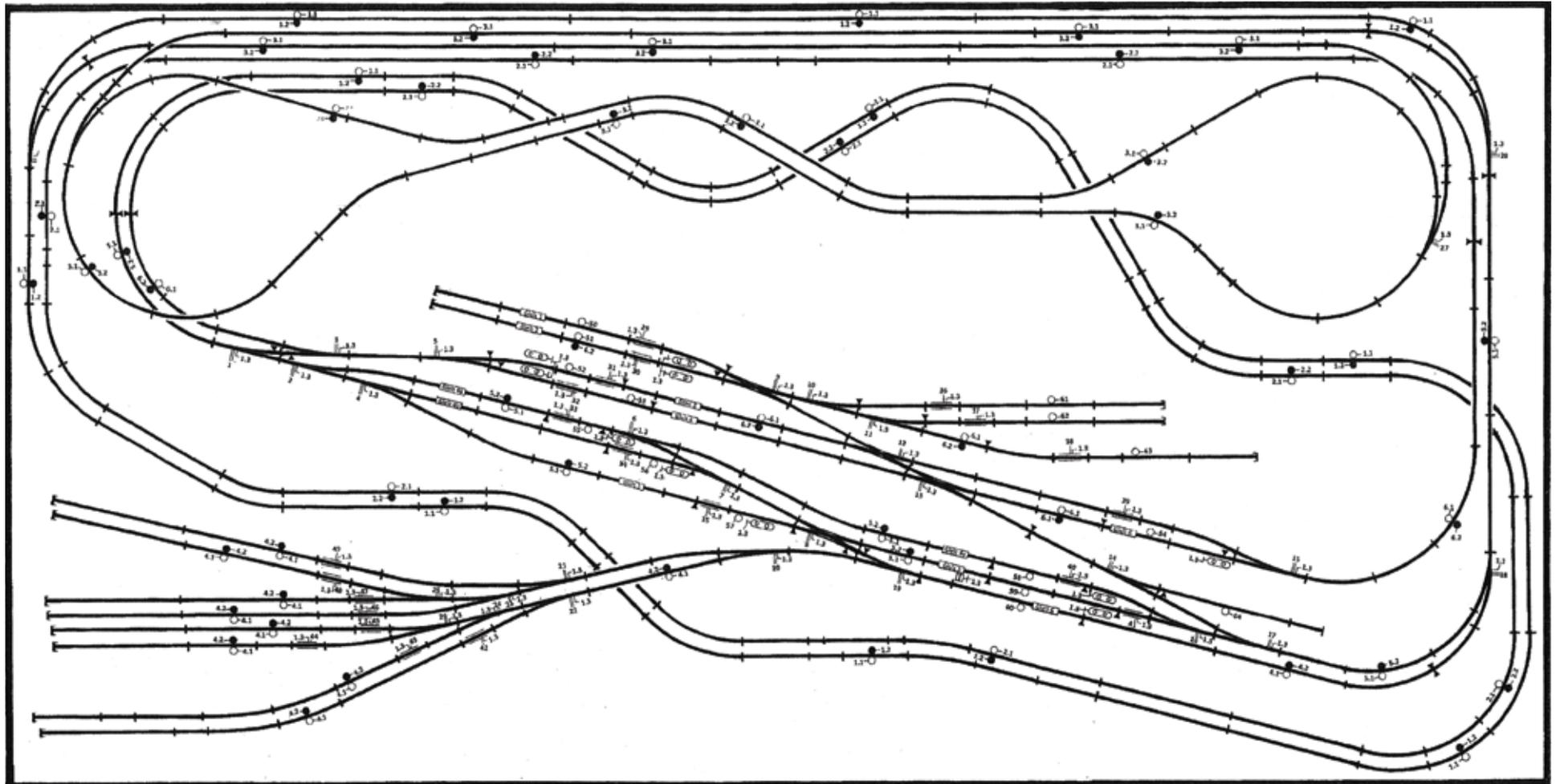
**Weisse Kreise an den Schienen:** Fahrstromanschluss rote Kabel
