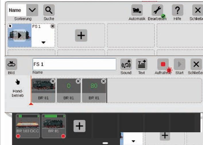
Parallel zur manuellen Eingabe besteht auch bei der CS3 die Möglichkeit, über eine Aufnahmefunktion Fahrstraßen und Abläufe zu erfassen. Ähnlich wie eine Videokamera zeichnet die CS3 dabei einen Ablauf auf und gibt ihn später wieder.
