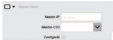
Sobald mehr als eine CS3 bzw. CS3 plus eingesetzt werden, bekommt dieser Abschnitt Bedeutung: Hier stellen Sie ein, welche CS3 das Hauptgerät (Master) und ob dieses Gerät ein Zweitgerät ist.
