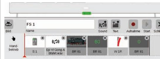
Schritt für Schritt lässt sich die Fahrstraße einfach per Drag & Drop zusammensetzen. Jeder einzelne Punkt (Geschwindigkeit, Signal- und Weichenstellungen etc.) kann dabei individuell angepasst werden (siehe folgende Seiten).
