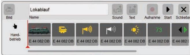
Durch das Antippen der Icons kann jede einzelne Funktion individuell eingestellt werden (Bilder unten). Über den Button „Start“ kann der gesamte Ablauf abgespielt/kontrolliert werden.
