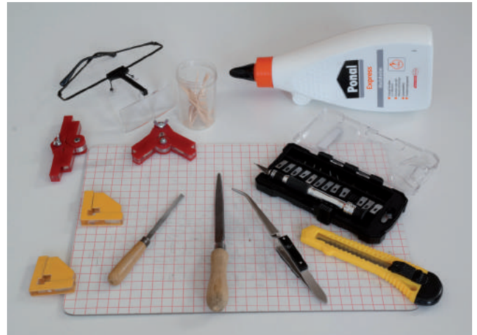
Bild 3: Nützliches Werkzeug – Bastelmesser, Schneidebrettunterlage, gekrümmte Pinzette, Magnetwinkel (oder gegenpolige Magnete), Feile, Lupenbrille, ein paar Zahnstocher.
