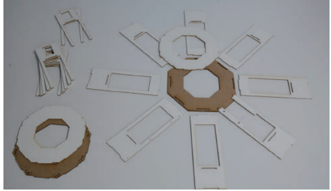
Bild 4: Zunächst werden Bodenplatte, Seitenwände der unteren Etage und der Zwischenboden miteinander verleimt.
