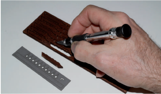
Bild 3: Alle Teile des Bausatzes sind per Laser vorgeschritten – bis auf einige Fixierstege, die man leicht durchschneiden kann.
