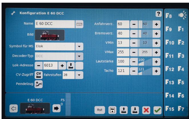
Mit einer CS2 kann man im DCC-Modus lange DCC-Lokadressen auch ganz einfach im Feld „Lok-Adresse“ eingeben und dann die entsprechenden Parameter in die Lok schreiben lassen (mithilfe des Pfeilfelds unten links neben der roten X-Taste). Die Berechnung der CV-Register 17 und 18 erfolgt dann mithilfe der CS2 vollkommen automatisch.
