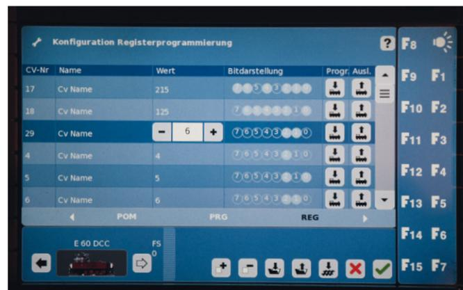
Die Speicherung einer langen Lokadresse im REG-Modus der CS2 in den CV-Registern 17 und 18 gemäß Berechnungsformel (siehe auch Kasten auf der linken Seite).
