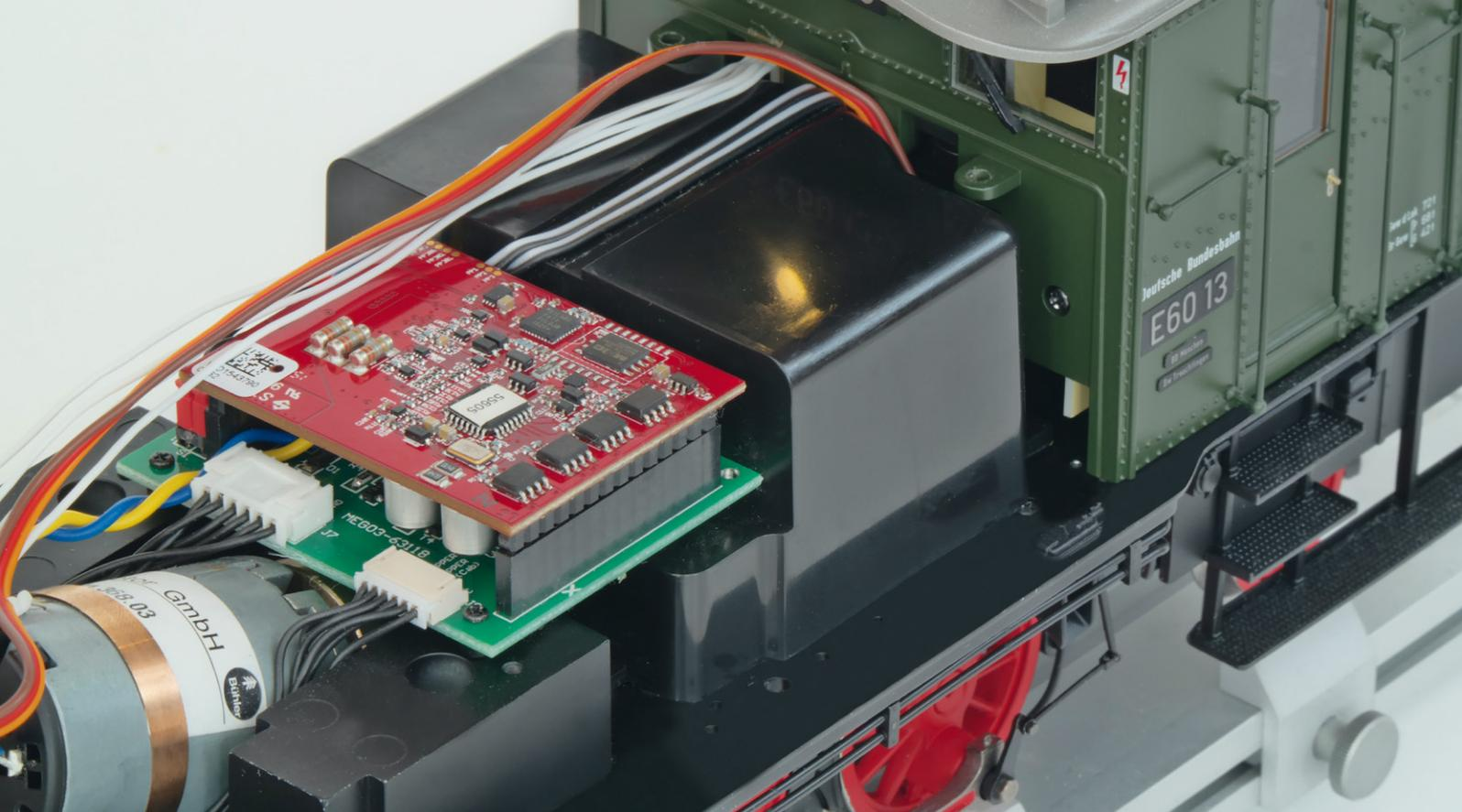
Der eigentliche Multiprotokoll-Decoder von Märklin ist 51 x 40 x 13 mm klein (im Bild die rote Leiterplatte oben) und hat an beiden Enden jeweils eine 14-polige Stiftleiste. Er lässt sich schnell und einfach auf die Haupt-Leiterplatte der jeweiligen Lok aufstecken.
