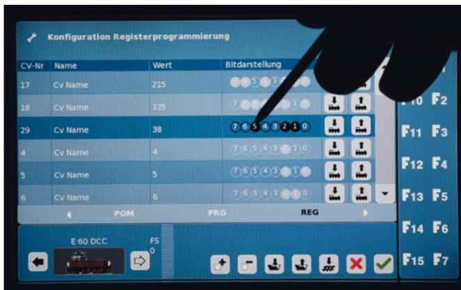
Umprogrammierung von Bit 5 des Registers 29 per Stift zur Freischaltung des Decoder-Betriebsmodus für lange DCC-Lokadressen.
