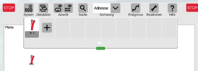
Eine neue Weiche ist angelegt – die Magnetartikel werden immer auf der gerade aktiven Platte abgelegt.
