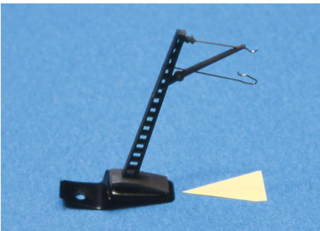
... nun wird ein Zwei-Millimeter-Befestigungsloch gebohrt. Der Mast wird mit Sekundenkleber am Sockel befestigt. Das vorn überstehende Teil (Pfeil) wird abgeschnitten.
