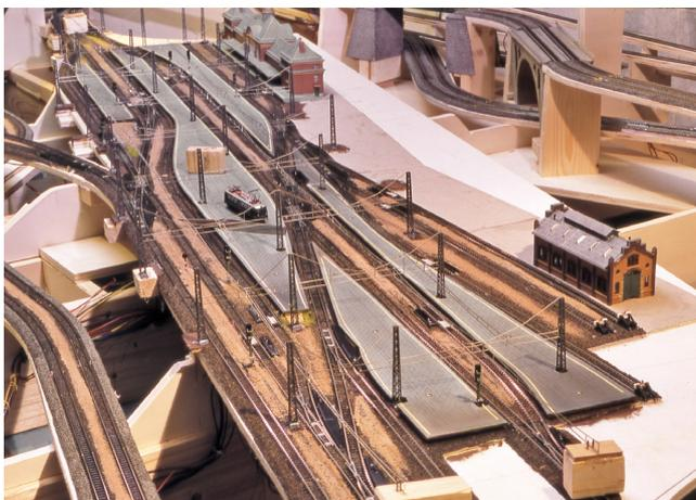
Die OL-Verlegung schreitet voran. Alle elf Quertragwerke sind bereits eingebaut und die ersten Fahrdrähte eingehängt.
