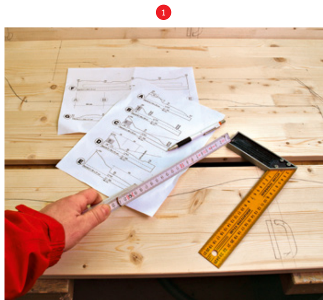
Frisch ans Werk: Die Konturen der Spanten werden vom Skizzenplan sorgfältig auf die Holzbretter übertragen.
