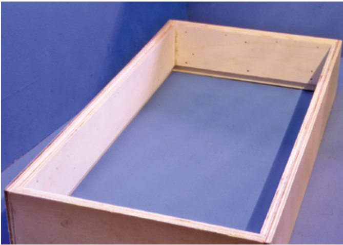
Hier sind die insgesamt acht Teile zum fertigen Stellpultrahmen zusammgebaut. Die inneren Auflageleisten liegen etwa fünf Millimeter unterhalb der Außenrahmenoberkante.
