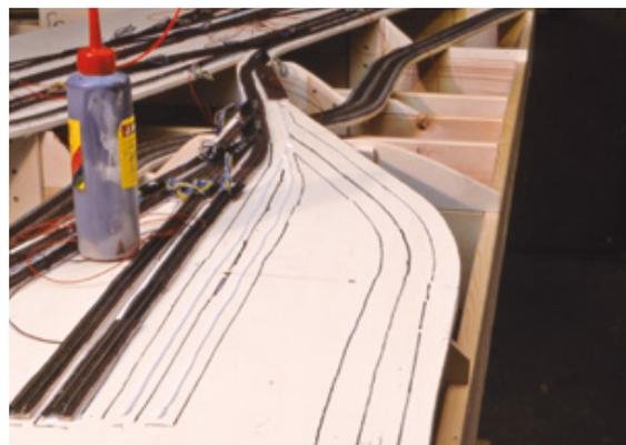
**Gleismittig entlang** der Markierungen wird nun eine schmale Kleberraupe aufgetragen. Dann wird der erste Gleisabschnitt aufgelegt.
