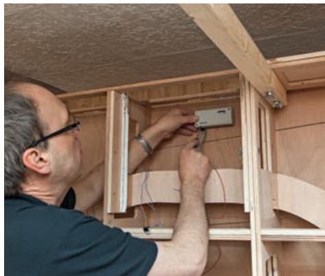
Unser s 88-Modul platzieren wir nahe der Central Station. Die Rückmeldekabel beschriften wir.
