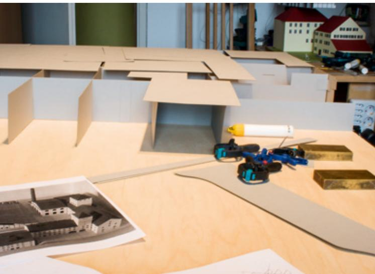
Deckel drauf: Abdeckplatten schließen das Gerüst nach oben – vor dem finalen Aufkleben lohnt sich ein Probeaufbau der Gebäude.
