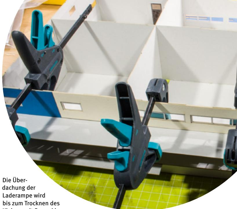
Die Überdachung der Laderampe wird bis zum Trocknen des Klebers mit Spannklemmen gut fixiert.
