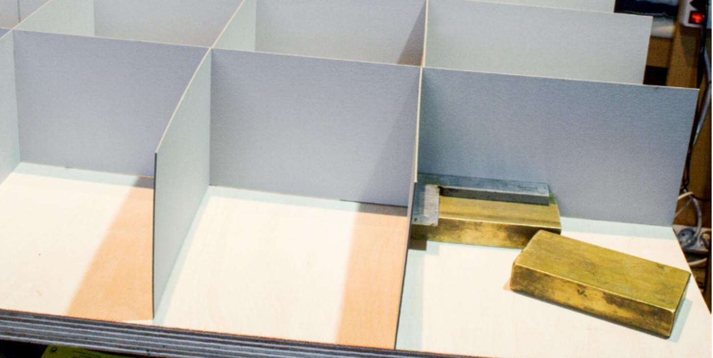
Ordnung zahlt sich aus: Die Winkel der Streben des Unterbaus werden vor dem Verkleben mit der Bodenplatte auf einen Winkel von 90 Grad geprüft und gegebenenfalls entsprechend ausgerichtet.
