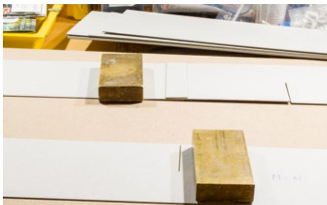
Vorarbeit: Die Streben des Unterbaus werden vor dem Einbau aus zwei Bauteilen zusammengeklebt.
