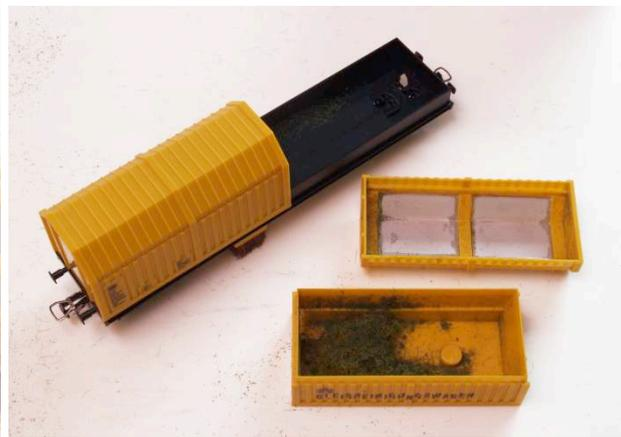
**Tipp:** den Schienenstaubsauber vor die Lok spannen und im Schiebetrieb fahren. Man glaubt es kaum, aber das Saugfahrzeug nimmt schon im ersten Durchgang so viel Schmutz auf, dass die Lok einwandfrei weiterfahren kann.
