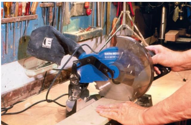
Zum **genauen Ablängen** der Rahmenteile eignet sich am besten eine Kappsäge. Die einzelnen Rahmenstreben müssen nach der Holzmaßliste auf den Millimeter genau zugeschnitten werden.
