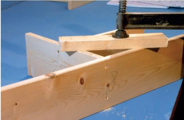
Zum **Verschrauben** einzelner Strebenkombinationen spannt man die Teile exakt rechtwinklig mit einer kräftigen Schraubzwinde und übergelegtem Kantholz auf der Arbeitsplatte fest, dann können die Schrauben leicht eingedreht werden.
