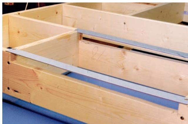
**Als Gleitauflage** für die Trafolade werden über den beiden Aussparungen Aluschiene befestigt. Das Foto zeigt den fertigen Ladenschacht, der Rahmen ist zur besseren Verdeutlichung umgedreht worden.
