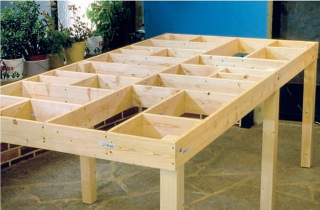
Wenn wir alles richtig gemacht haben, sieht unser fertiger Grundrahmen wie auf diesem Foto aus. Als Nächstes können nun schon die Geländespanten und anschließend die Gleistrassen eingebaut werden.
