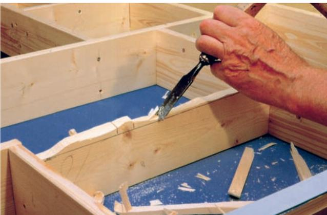
Beim Herausarbeiten des Schachtes an den Rahmenunterkanten werden die groben Vorarbeiten mit einem breiten Stemmeisen getätigt. Sollte (wie hier) zufällig ein Ast im Wege stehen, müssen dort mehrere Senkrechtschnitte angebracht werden.
