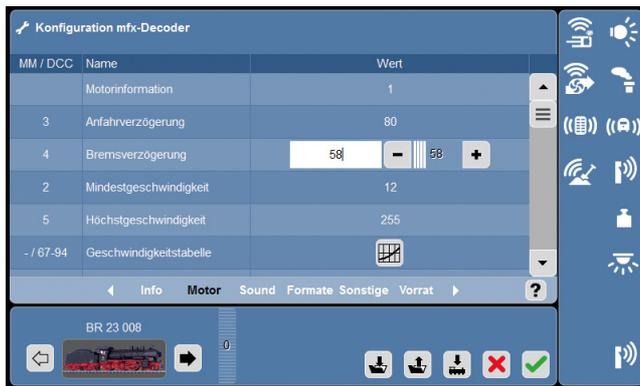
Bei Loks mit programmierbaren Märklin Decodern kann im Untermenü „CV-Zugriff“ die Anfahr- und Bremsverzögerung des Lokdecoders eingestellt werden.
