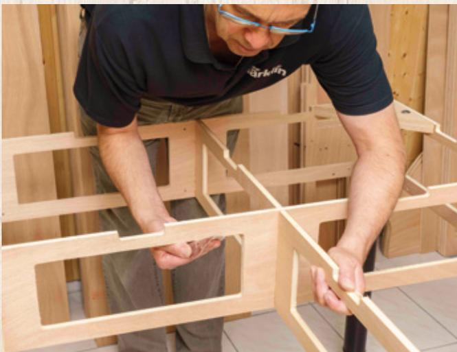
Bevor es an den weiteren Zusammenbau geht, können die Fräskanten der Module noch etwas verschliffen werden. Im Hintergrund zu sehen: Die Anlagenbeine sind bereits an die Multiplexplatten angeschraubt.
