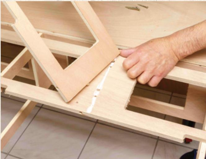
Anschließend stecken wir die Dübel der Querverbindung in die dafür vorgesehenen Dübellöcher.
