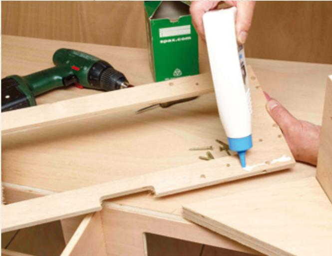
Unsere Unterbaumodule aus dem Hause Peter Fischer sind bereits fix und fertig vorkonfektioniert. In die Dübellöcher geben wir etwas Leim, um die Festigkeit der Konstruktion zu erhöhen.
