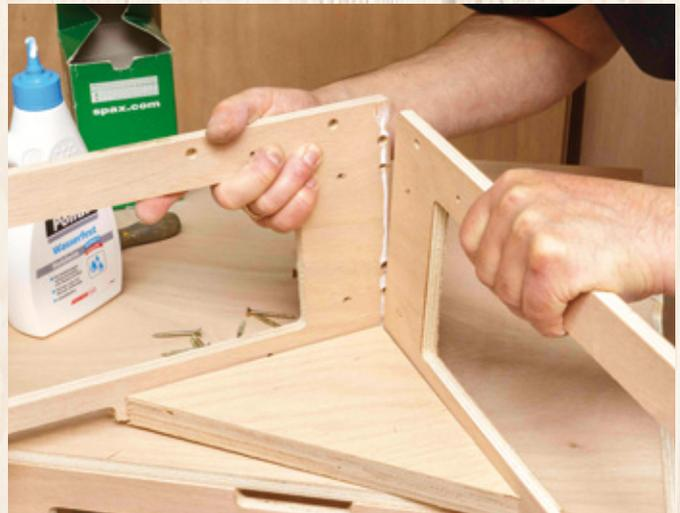
Auch an den Ecken verfahren wir so. Auf dem Foto sieht man auch gut die zum Dreieck gesägte Multiplexplatte, die uns als Aufnahme für die Beine dienen wird.
