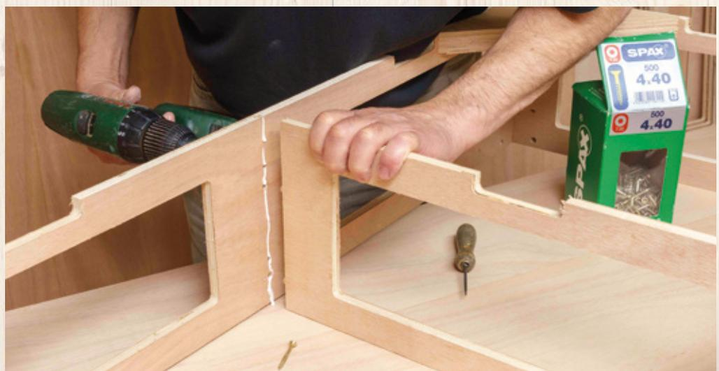
Und wieder werden die Spannten mit Dübeln, Leim und Spaxschrauben verbunden – das hält sicher.
