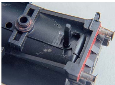
Die Kulissenführung ist eingeklebt. Mit aufgestecktem Schacht wird die Funktion geprüft.
