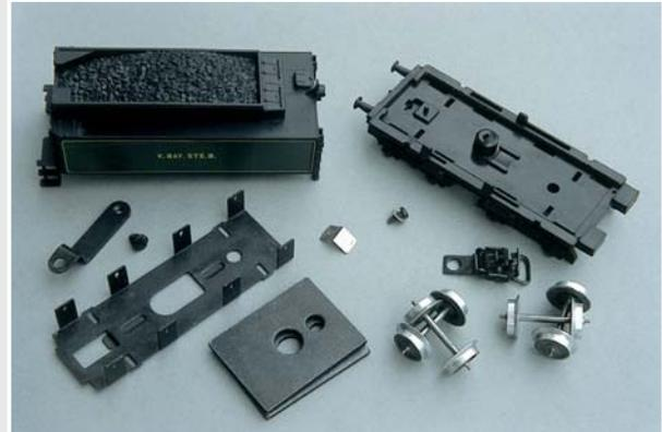
*Für den Einbau einer Kulissenführung muss der S 3/6-Tender komplett zerlegt werden.*
