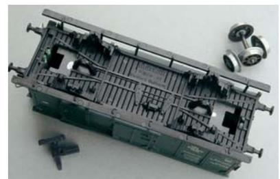
**Wagen-Zusammenbau vor dem Einkleben. An beiden Enden unterschiedliche Montage-Abstände der Kinematik. Die erhaltenen Spreizverankerungen fixieren Gehäuse und Beschwerung ohne Kleber.**
