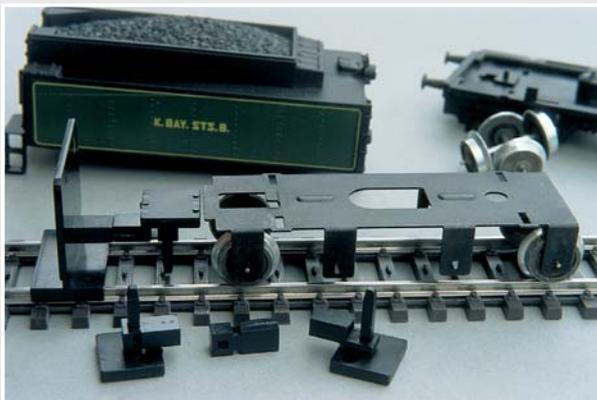
*Überprüfung der Kuppelhöhe mit verschiedenen Artikeln aus dem SYMOBA-Programm.*
