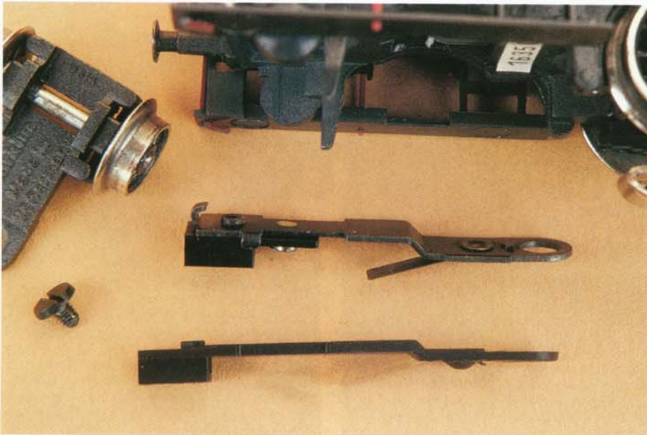
Umbau der E-Lok 160 unter Verwendung der alten Kupplungsdeichsel und dem Schacht 288390: Diese Lösung ist stabil und kuppelt sehr kurz
