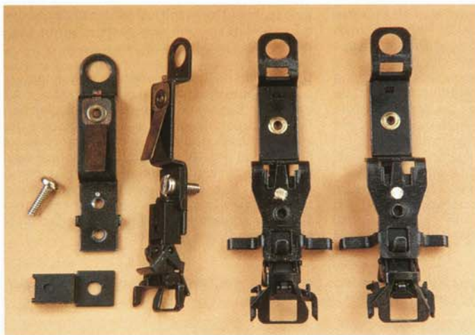
Kupplungswechsel in vier Schritten: Bei den mittleren Deichseln ist die Schraube noch nicht bzw. nicht ganz gekürzt, die rechte ist fertig zum Einbau
