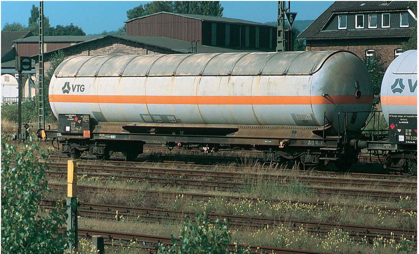
Gaskesselwagen gibt es in sehr unterschiedlichen Ausführungen. In diesem Fall ähnelt die Kesselbefestigung der Version des Märklin-Modells. Die Sonnenblende schützt vor zu starker Erwärmung
