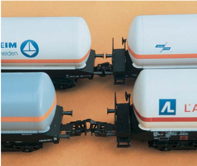
Bei gestrecktem Zugverband rechtfertigt der durch den Umbau erzielte optische Gewinn sehr puffernah gekuppelter Kesselwagen auf jeden Fall den durchwegs überschaubaren Bastelaufwand
