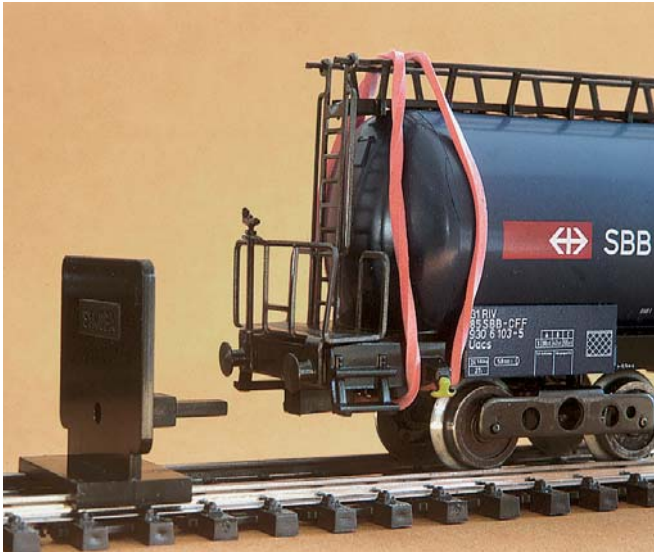
Die auf die Schienen aufgesetzte Symoba Justier-Lehre (Nr. 102) erleichtert die Kontrolle sowohl von Höhe als auch Montageabstand der Kulissenführung vom Schacht zur Pufferbohle
