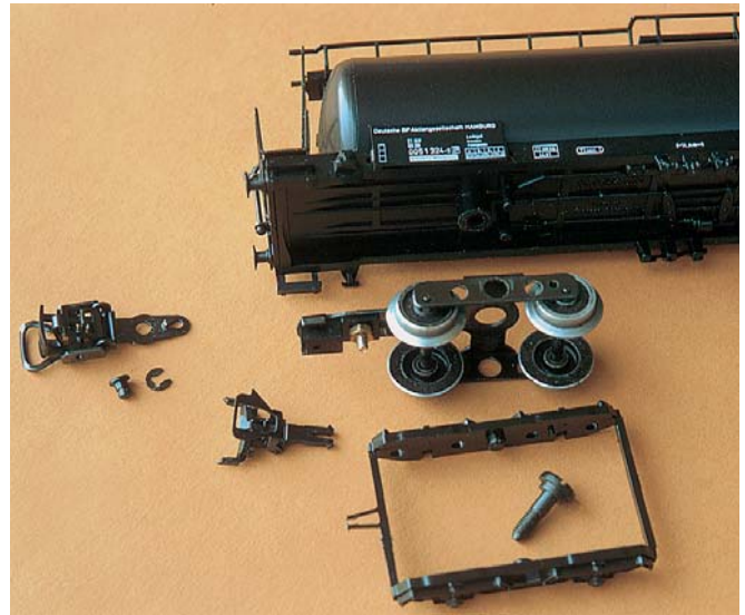
Der Umbau mit einem am Mineralölwagen-Drehgestell starr angeschraubten Schacht ist nur bedingt praxistauglich: Bei engen Standardradien oder Gegenbogen können die Wagen entgleisen
