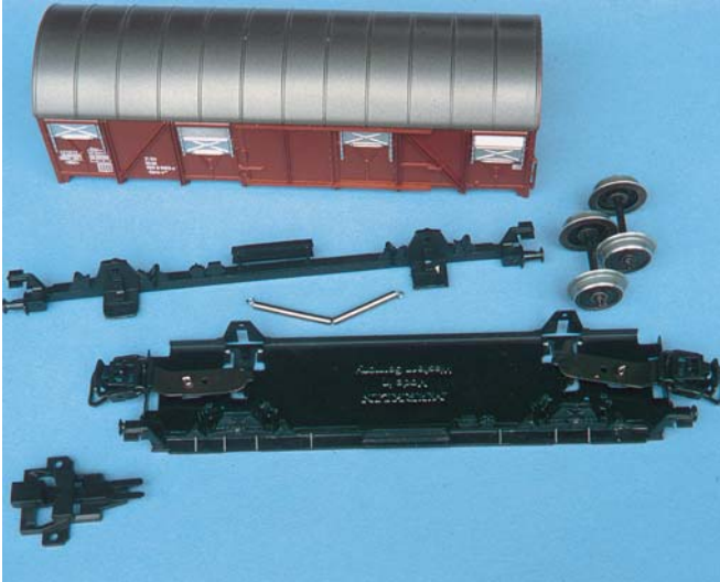
Eine komplette Zerlegung des Wagens ist nur erforderlich, wenn man beabsichtigt, den Wagenboden auf die ruppige Weise mit dem Hammer zu glätten
