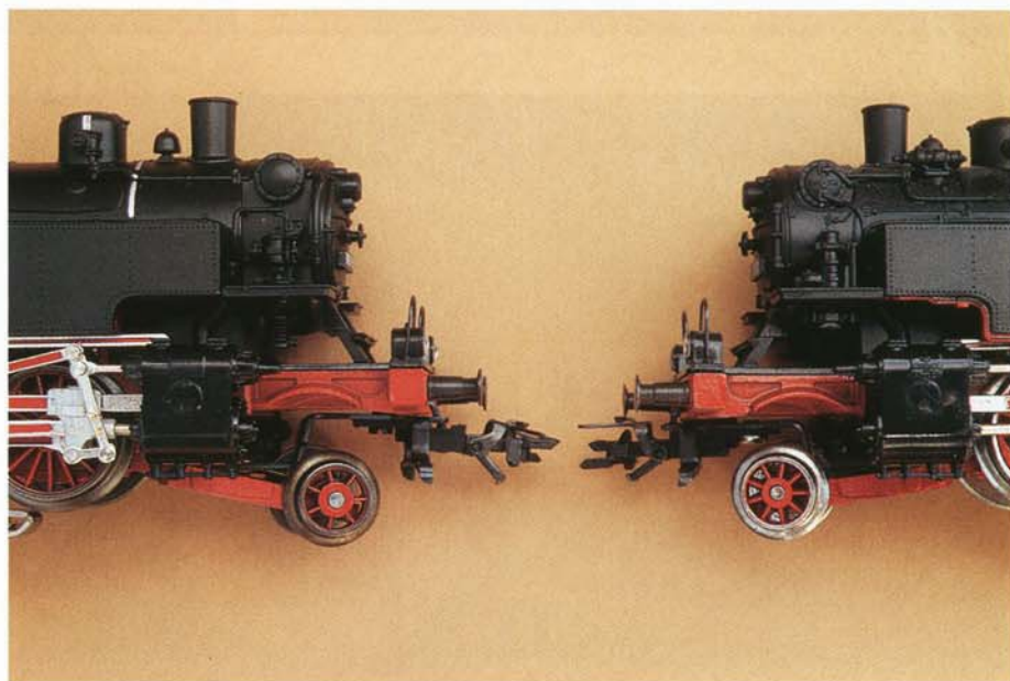
Beachtliche Verkürzung des Kuppelabstandes gegenüber der Serienlieferung: Es würde sich lohnen, auch die Kupplung der linken 86-er zu verbessern
