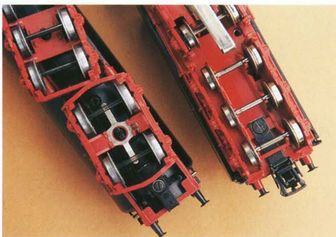
Die Borsig-Lok (links) ist fertig umgerüstet. Der BR 012 steht dies noch bevor. Gut sichtbar: Der Führungssteg muss abgetrennt werden
