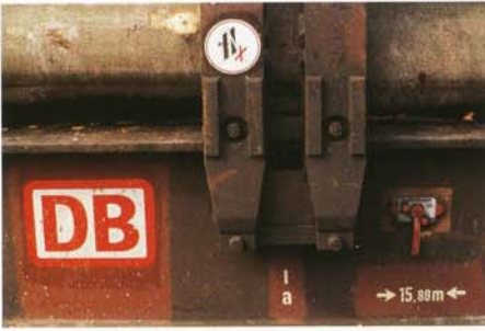
Am Hauptbremshebel steht die Druckluftbremse in eingeschalteter Position. Vor wiederholten Neubeschriftungen wurde die Wagenlackierung nur partiell erneuert
