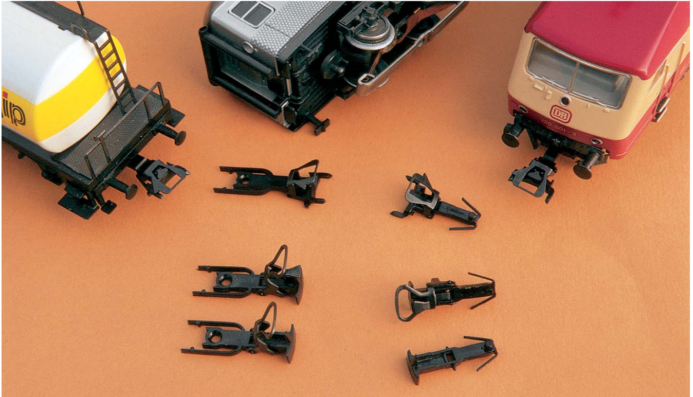
Alte und neue Kupplung: Außer Relex-Kupplungen lassen sich auch Bügelkupplungen von Personenwagen und Lok-Kupplungshaken austauschen
