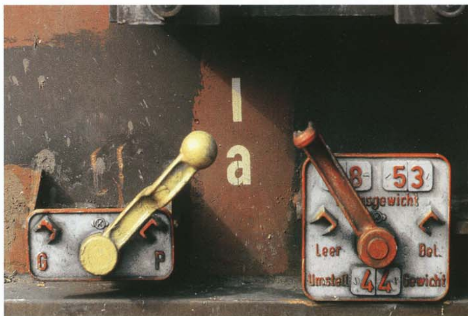
Zugartenumschalter und Bremsstellhebel für das Wagengewicht: Ab 44 t wird der Hebel nach rechts umgelegt
