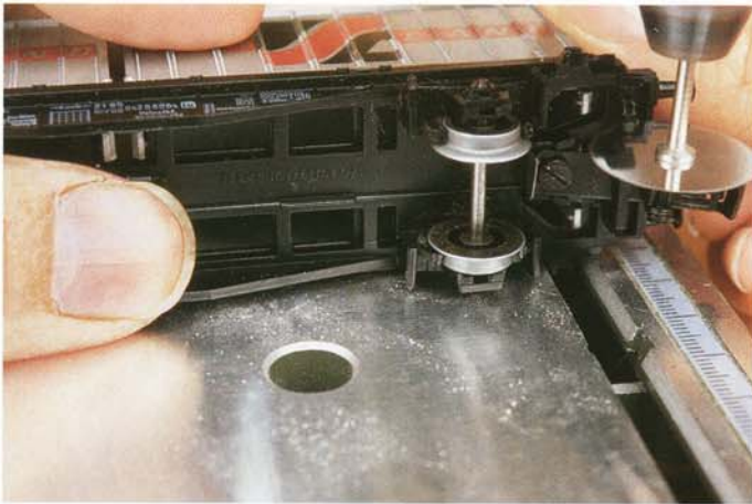
Mit fest eingespannter Mini-Bohrmaschine lassen sich die Abtrennarbeiten besonders rationell ausführen
