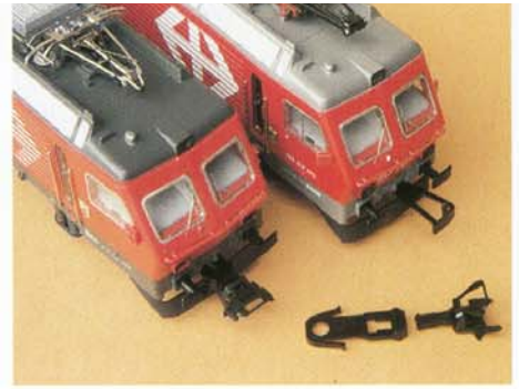
Zwei SBB-Lokomotiven der Reihe Re 4/4. Die linke wurde bereits mit Kurzkupplung geliefert. Für die andere liegt das Ersatzteil 404020 bereit
