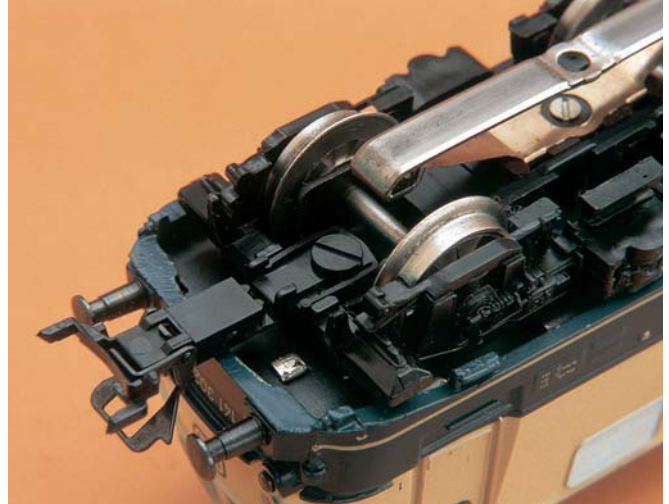
Entgegen der normalerweise vorgesehenen Einbaulage kann im Einzelfall evtl. eine gedreht montierte Deichsel den Kupplungstausch ermöglichen
