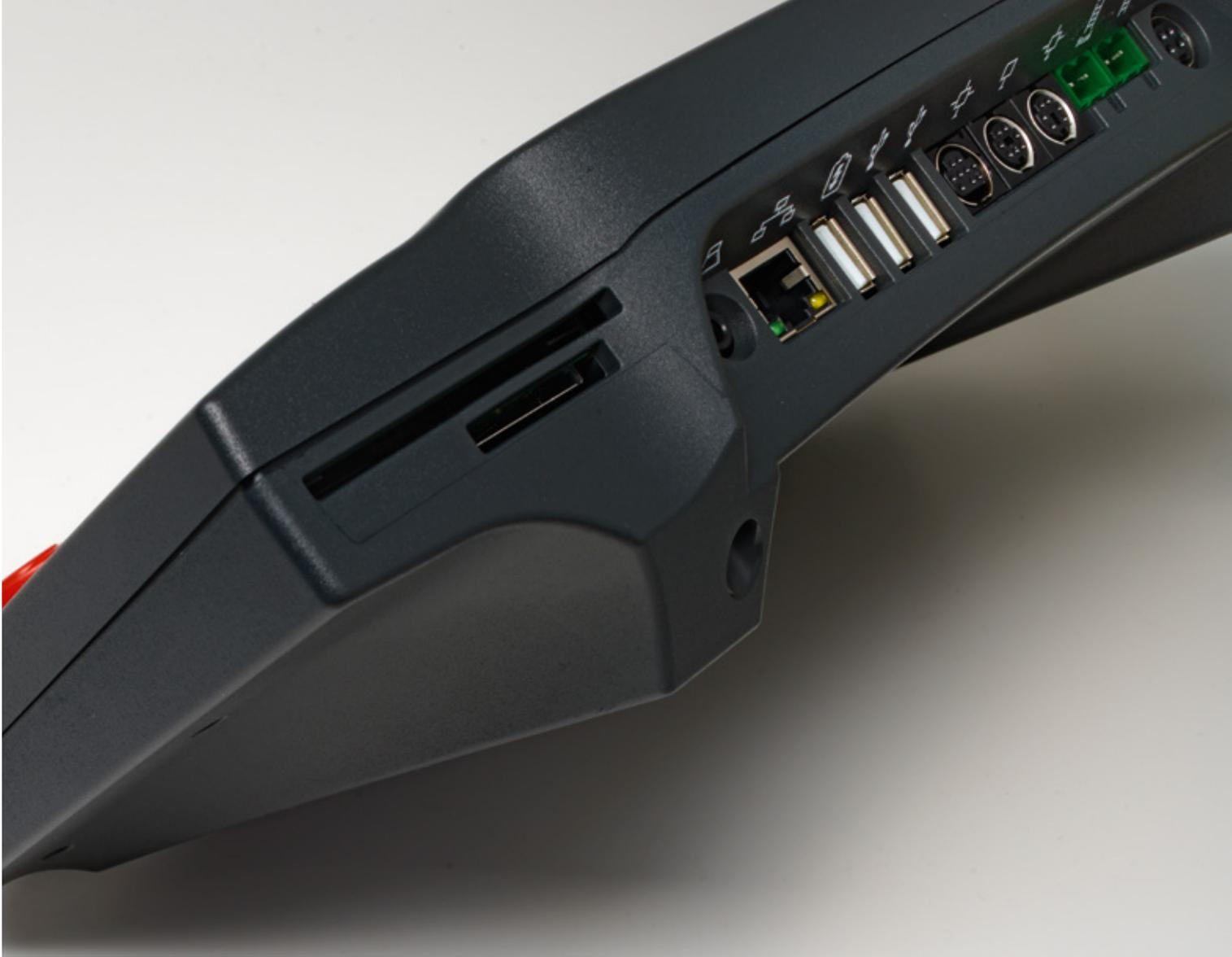
**Kontaktfreudig:** Bis zu zwei USB-Geräte können an die neue Central Station angeschlossen werden – etwa eine Maus, eine Tastatur oder ein Speicherstick. Apropos Speicher: Vier Gigabyte internen Speicher bringt die CS3 mit – er lässt sich um bis zu 32 Gigabyte erweitern.
