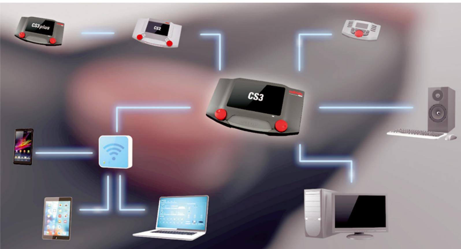
Dreh- und Angelpunkt: die CS3 und die CS3 plus. Vom PC über Internetrouter bis hin zur Lautsprecherbox kann alles an eine Central Station 3 angeschlossen werden – mit der CS3 plus sogar weitere Central Stations. Von der CS3 kann ein Exemplar im Gesamtsystem eingesetzt werden.
