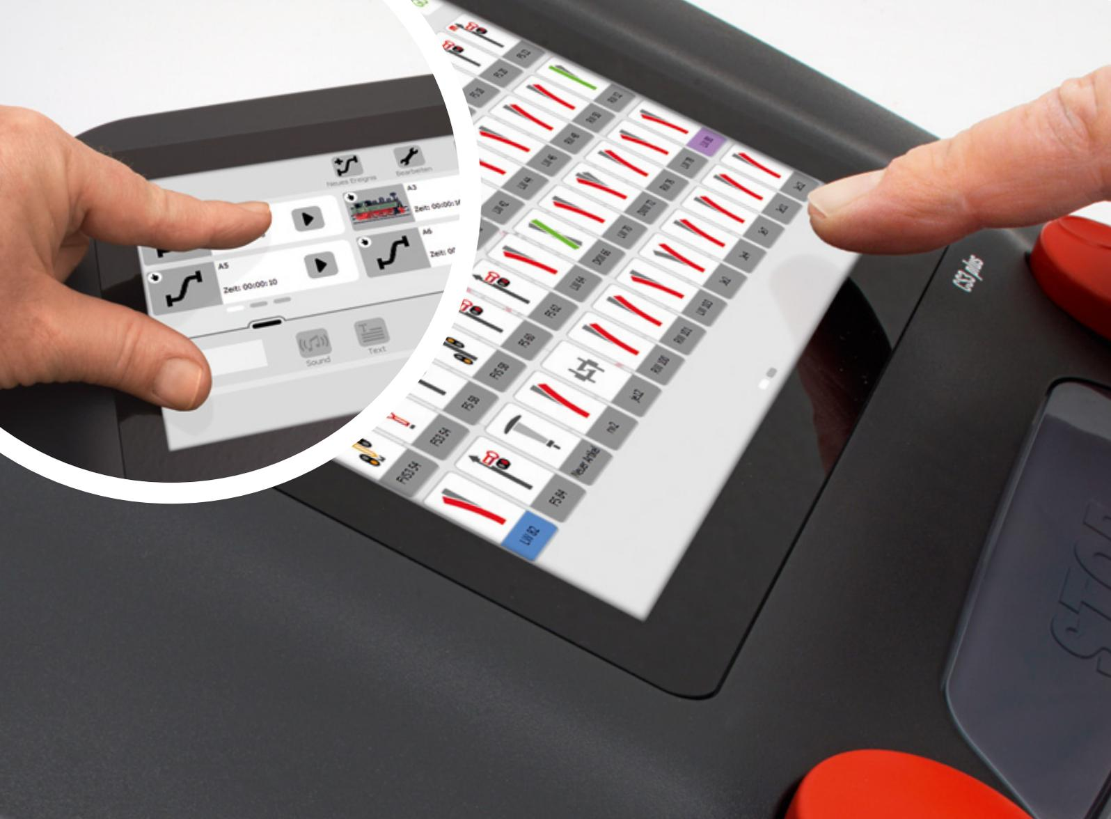
Neue Steuerung: Wer sich mit Smartphone und Tablet auskennt, wird mit der Bedienung der Central Station 3 keine Schwierigkeiten haben. Um das Layout zu vergrößern, zieht man es mit Daumen und Zeigefinger „auseinander“.
