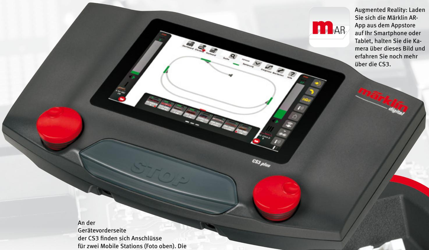
An der Gerätevorderseite der CS3 finden sich Anschlüsse für zwei Mobile Stations (Foto oben). Die CS3 plus verfügt zudem an der Unterseite über einen direkten S88-Anschluss (Foto rechts).
