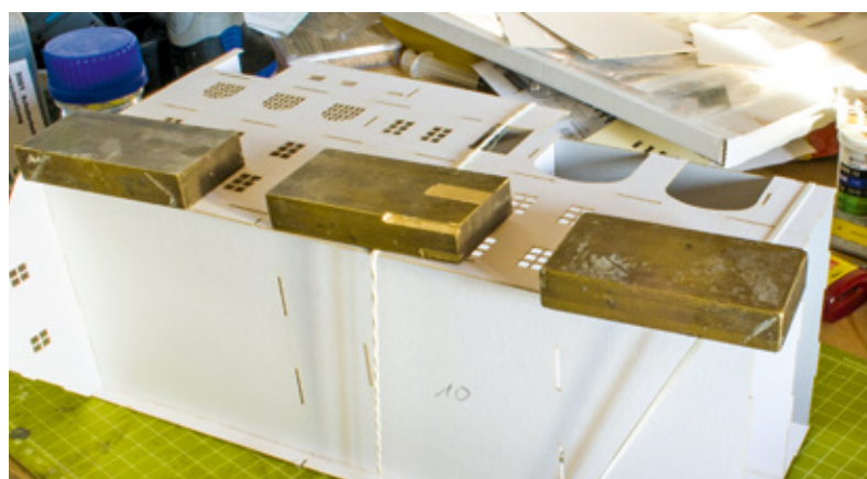
Nachdrückliche Fixierung: Gummiringe und Messinggewichte halten, während der Kleber trocknet, die Seitenwand des Wohngebäudes in der gewünschten Lage.
