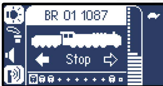
Synchrone Anzeige 1: Auf der CS3 ist rechts im Fahrregler die aktuelle 01 1087 und deren Fahrstatus zu sehen. Alle weiteren verbundenen Steuergeräte, wie die MS2, zeigen dieselben aktuellen Werte an, sobald diese Lok ausgewählt wird.
