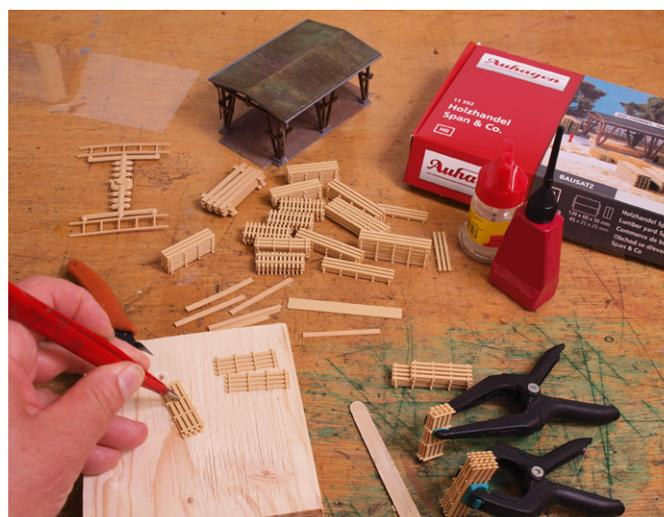
**Aufbau des Holzlagers:** Kleine Klemmen halten die verklebten Bauteile in Position, bis der Kleber getrocknet ist.
