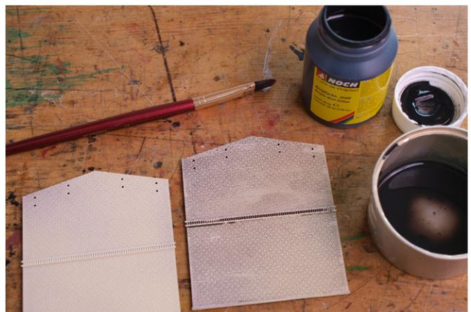
Klar konturiert: Mit verdünnter schwarzer Farbe werden die Mauerfugen hervorgehoben.
