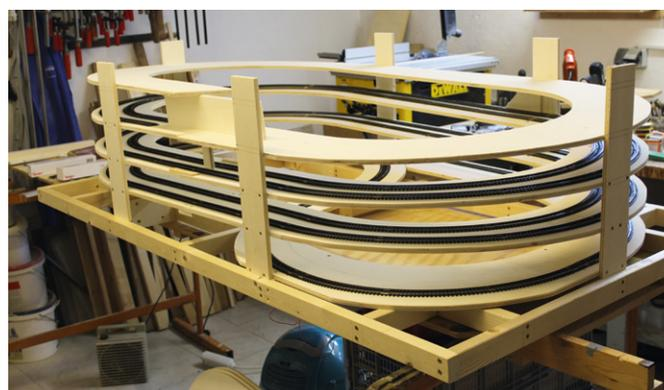
Die Trassen für die Kreise wurden aus ganzen Platten aus leichtem 10-Millimeter-Pappelsperholz herausgesägt.
