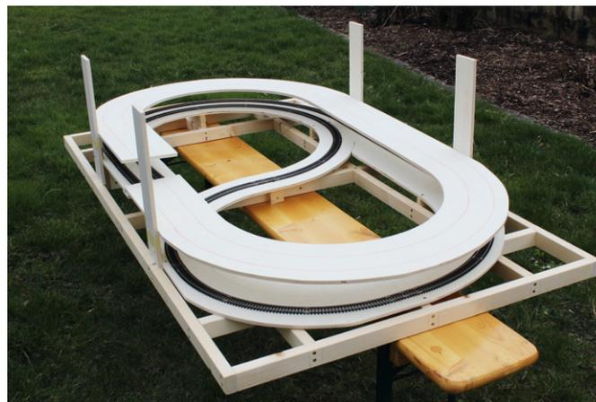
Verwendet wurden die Märklin K-Gleis-Radien 1 und 2. Eine Windung hat im ovalen Innenkreis eine Gleislänge von 370 Zentimetern.
