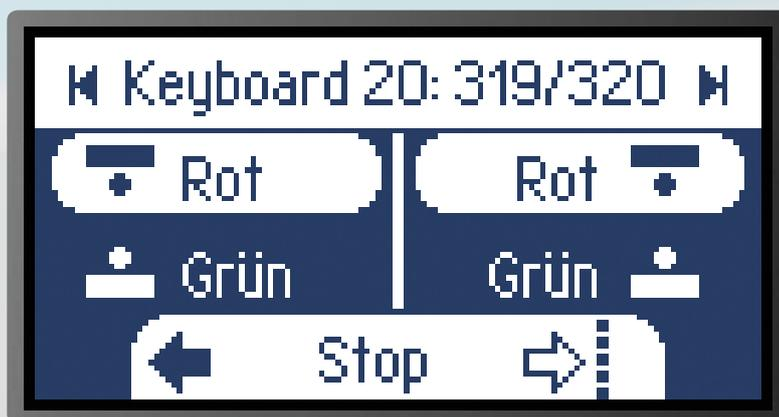
Da geht was: Maximal 320 Magnetartikeladressen lassen sich mit der MS2 ansteuern.
