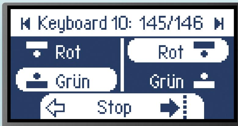
Um schnell zu den höheren Keyboards zu wechseln, halten wir die oberen Tasten gedrückt oder nutzen die Tastenkombination SHIFT + Fahrregler.
