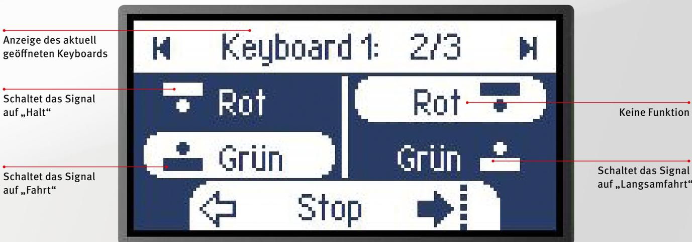
Willkommen in der MS2-Schaltzentrale: Das oben abgebildete, auf die Adressen 2 und 3 eingestellte Flügel signal 70412 wird von hier auf Knopfdruck gesteuert. Pro Adresse sind zwei Schaltzustände möglich.
