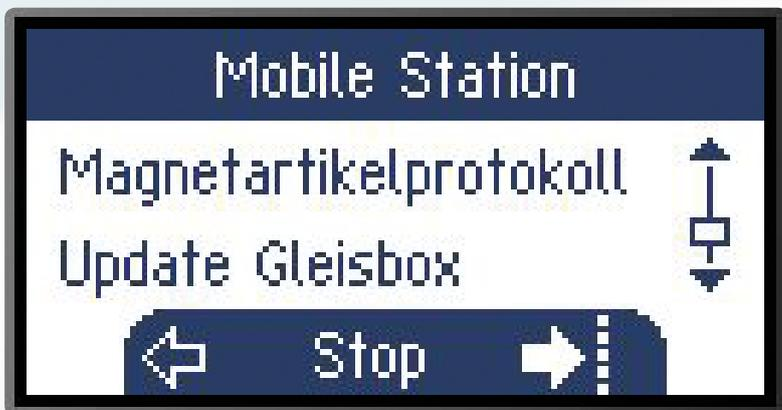
Mit SHIFT + Magnetartikeltaste wird das Einstellungsmenü geöffnet. Dort scrollen Sie mit den beiden mittleren rechten Tasten zum Eintrag „Magnetartikelprotokoll“.
