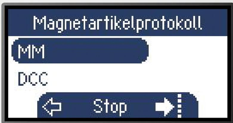
Mit der Taste links neben dem Menüeintrag „Magnetartikelprotokoll“ gelangen Sie zur Auswahl zwischen dem MM- und dem DCC-Format.
