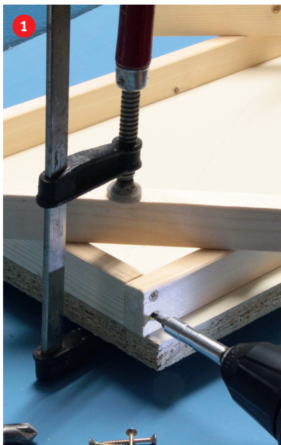
Exakt planeben sieht unser Pultrahmen aus, wenn wir ihn zum Verschrauben auf eine ebene Platte spannen.
