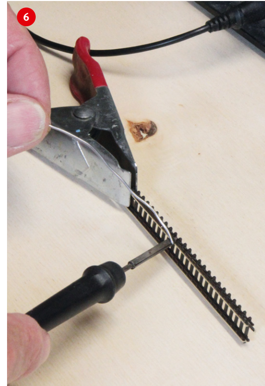
Bestens gelingt das Anlöten der Fahrstromkabel, wenn das Gleisstück mit einer Klammer oder Ähnlichem in Senkrechtstellung fixiert wird.
