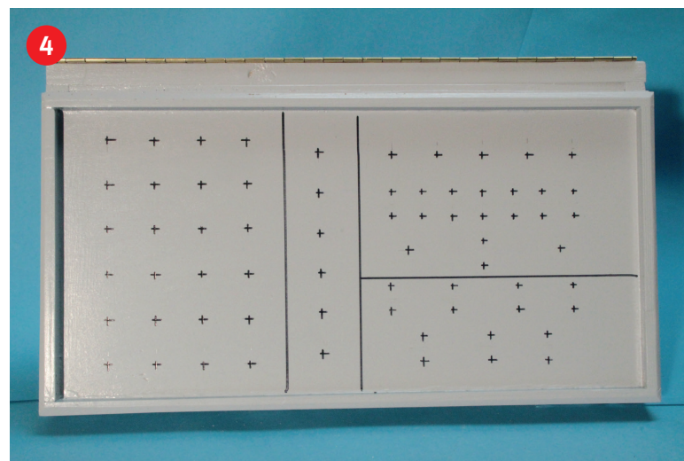
Auf der Pultplatte sind bereits alle Bohrstellen für die Schalter und Taster markiert. Damit der Bohrer nicht verläuft, werden die Stellen punktgenau mit einem spitzen Dorn vorgestochen.
