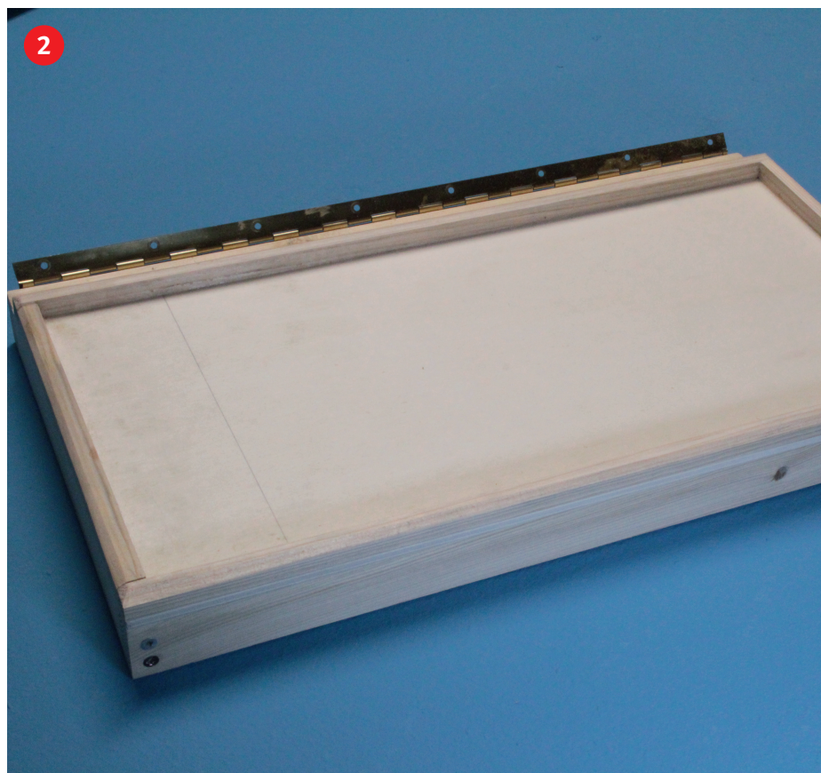
Damit der Rahmen an Ort und Stelle eingebaut werden kann, müssen wir an der hinteren Rahmenkante ein Scharnierband anbringen.
