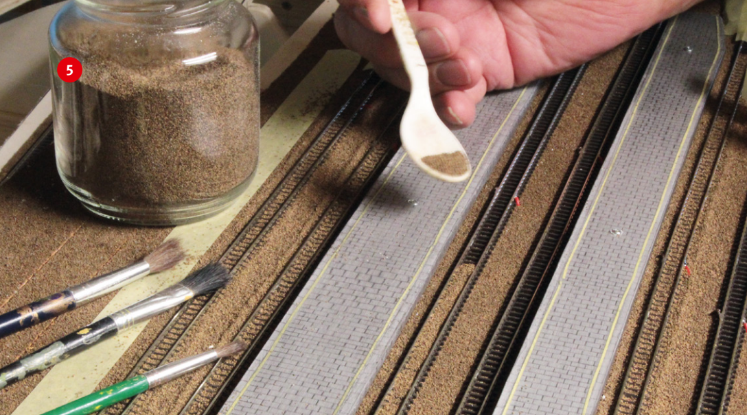
Mit dem Teelöffel wird das Schottermaterial eingestreut und anschließend mit dem Pinsel ausgerichtet, wobei sich beidseits der Schienen eine sogenannte Schotterkrone bildet.
