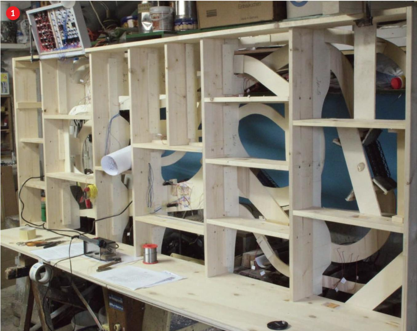
In handlicher Höhe ist die Anlage hochkant aufgestellt. So ist der Unterbereich bis hin zur äußersten Ecke leicht und übersichtlich zugänglich. Die Werkzeuge liegen schon bereit und das Stellpult ist nach oben ausgeklappt.
