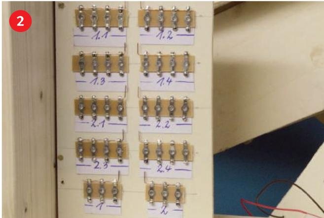
An zentraler Stelle im Unterbereich installieren wir einen Verteiler, zu dem die acht Klemmen der beiden Trafos vorverlegt werden. Der Verteiler hat praktisch die Funktion der altherkömmlichen Märklin Verteilerplatten Artikel 72090.
