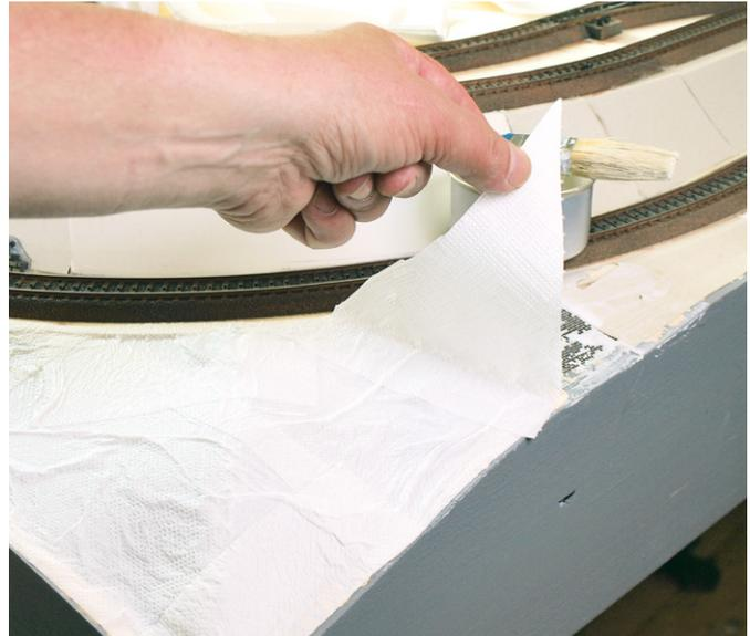
Die zweite Schicht der Geländehaut: Die kleinen Küchenpapierstücke werden auf das zuvor eingeleimte Fliegengitter geklebt.
