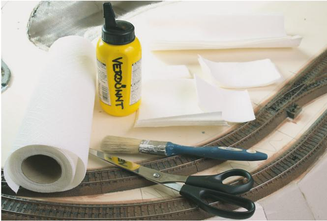
Schere, Leim, Papier: Mit der Schere wird das Küchenpapier geteilt, mit dem Pinsel der Holzleim auf Karton und Gitter verteilt.
