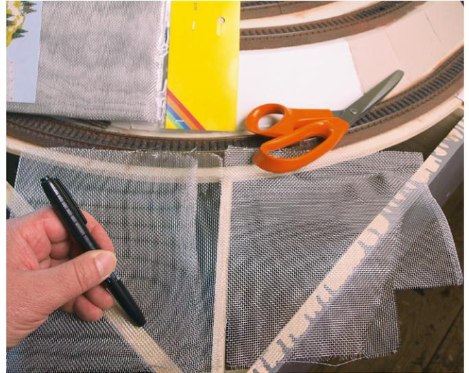
**Leichte Grundlage: Mit Fliegengitter werden die größeren verbliebenen Lücken überspannt.**
