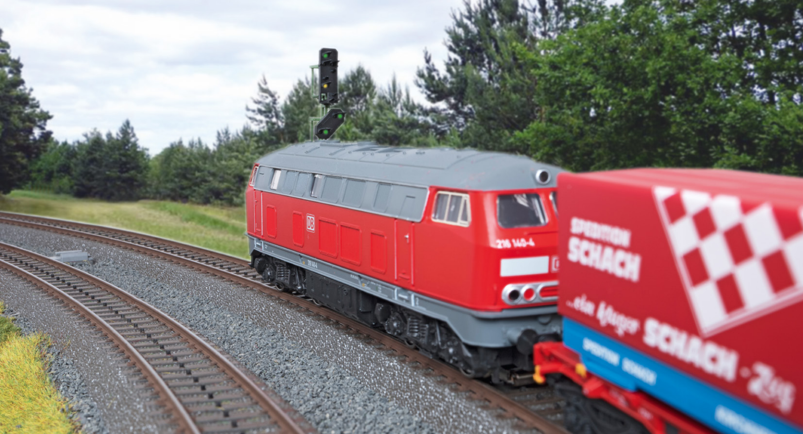
Erste Wahl: Hauptsignal mit am Mast montiertem Vorsignal. Der Abstand zwischen Haupt- und Vorsignal lässt sich sonst auf der Modellbahn kaum vorbildgerecht darstellen.
