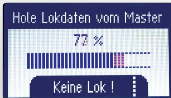
Danach liefert die Master-MS2 die Lokdaten ans Zweitgerät. Bis zu zehn Loks können in die Slave-MS2 übertragen werden.
