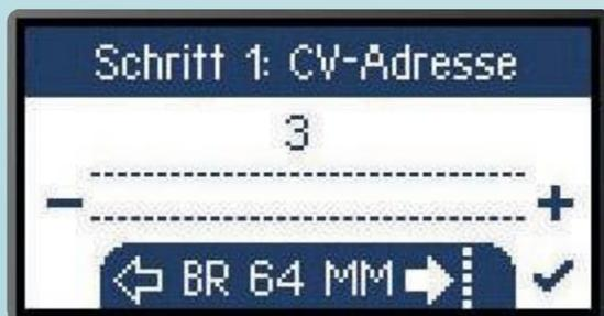
Die CV für die Anfahrverzögerung ist in CV 3 zu finden. Je nach Einstellung bremst oder beschleunigt die angesprochene Lok nun langsam oder ziemlich flott.
