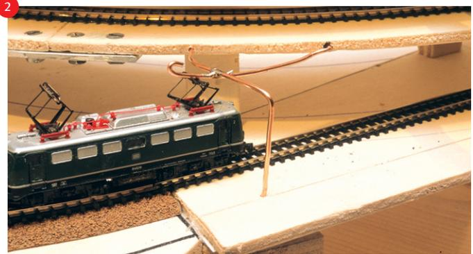
2 An den Tunnelausgängen müssen sogenannte Auflaufhörner eingebaut werden, damit sich der Stromabnehmer der E-Loks bei der Ausfahrt nicht verhakt.
