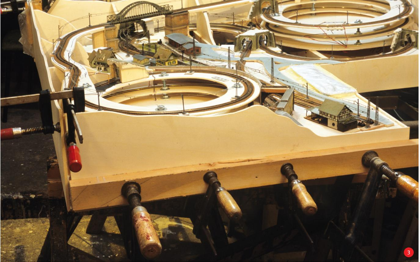
Beim Anleimen der Außenblenden mit kräftigen Schraubzwingen legt man zur Schonung der Holzoberfläche und gleichermaßen zur Verteilung des Anpressdrucks ein Kantholz bei. Die Ecken werden innen mit angeleimten Vierkanthölzern miteinander verbunden. Das Gleiche geschieht bei den Spanten.
