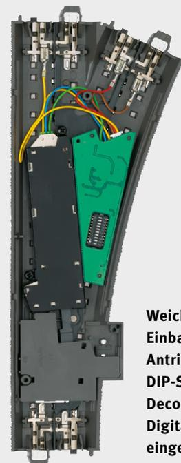
Weiche mit Einbaudecoder und Antrieb: Mit den DIP-Schaltern des Decoders wird die Digital-Adresse eingestellt.
