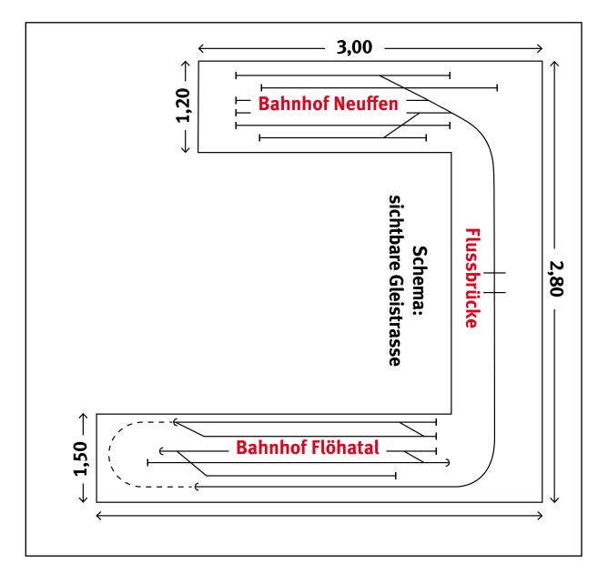
"U-Bahn" made in Mitterteich: Der hufeisen-förmige Grundriss nutzt die Raumbedingungen optimal aus. Der linke Arm beherbergt den Bahnhof Neuffen, der rechte Flügel Flöhatal.
