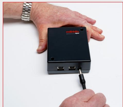
Eine Gleisbox (Art. 60116) kann bis zu zwei Mobile Stations 2 direkt aufnehmen. Die Buchse für das Netzteil befindet sich ganz rechts.
